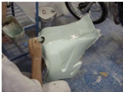
El proceso se realiza en toda la pieza sin dejar ningún espacio sin llenar, con esto se consigue un molde en optimas condiciones para una producción en serie.
