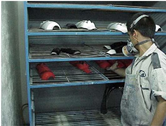
fig 68 horno de secado
