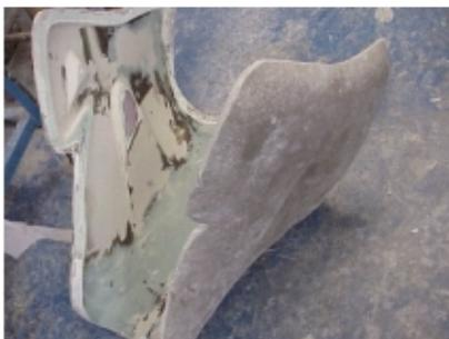
Después de vertir resina reforzada con fibra de vidrio y se logra una capa lo suficientemente gruesa se obtiene el molde para el prototipo.
