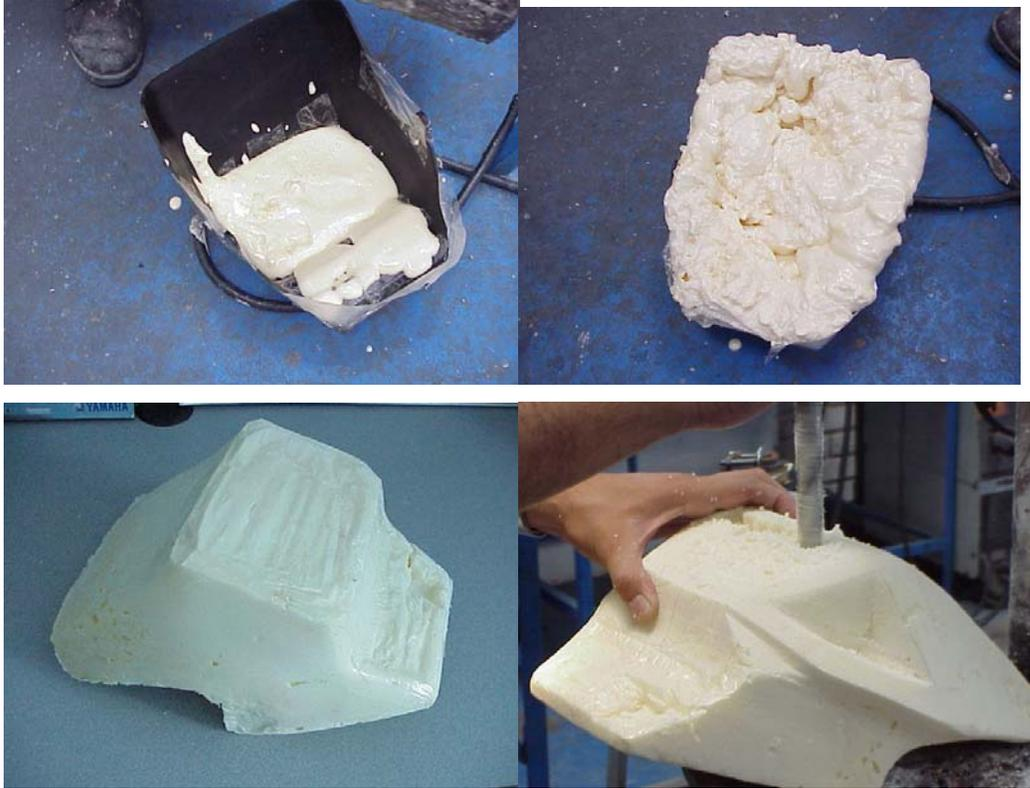
Como proceso de Diseño Se realizaron pruebas en espumas para mejorar su ergonomía, cambiando su forma original por una mas eficiente y antideslizante, se le cambio la idea a las mismas ensambladoras de innovar en los sillines y poco a poco lo hemos logrado.
