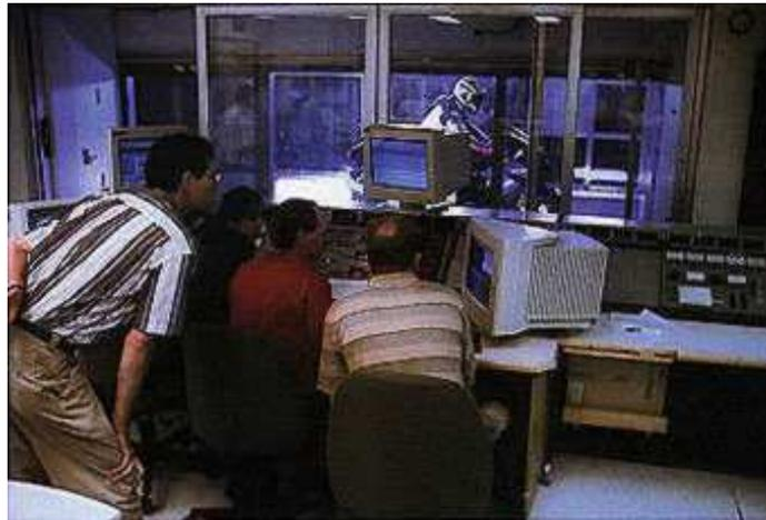
El él fabricante de vinos de Keven, dejado, supervisa a personal del NRC que se prepara para un funcionamiento. La bici se coloca en una viga del balance y se pone a cero el peso. Una placa giratoria cambia el ángulo de la bici contra el viento.
