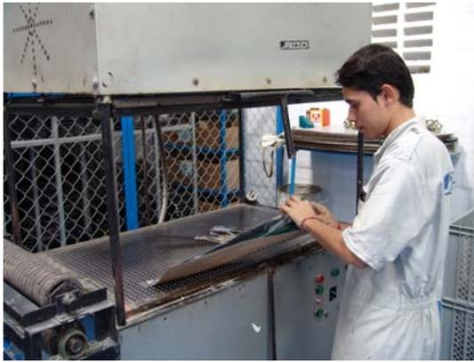
fig 70 maquina termoformadora
