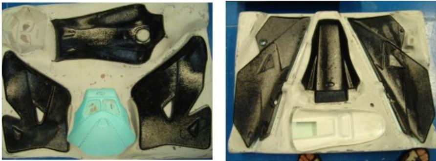
Fig 91 moldes realizados en resina para el proceso de termoformado.
