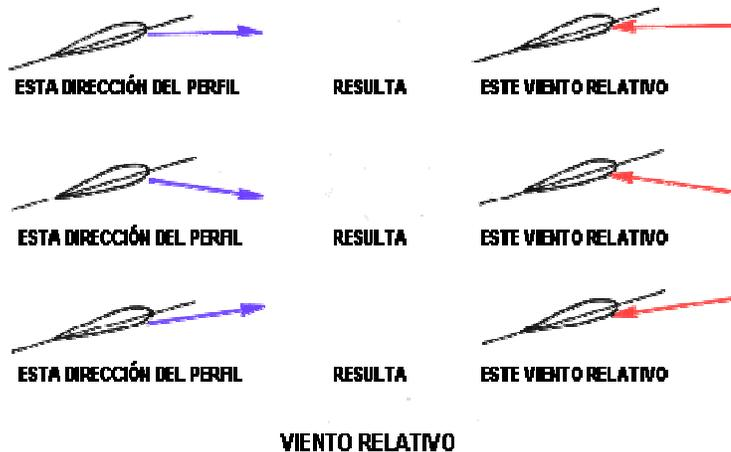
El conocimiento y significado del Viento Relativo es esencial para el entendimiento de la aerodinámica sobre las alas rotativas. El Viento Relativo es definido como el flujo de aire "relativo" que ataca a un perfil.
