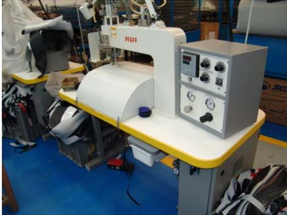
fig 63 maquina de termosellado
