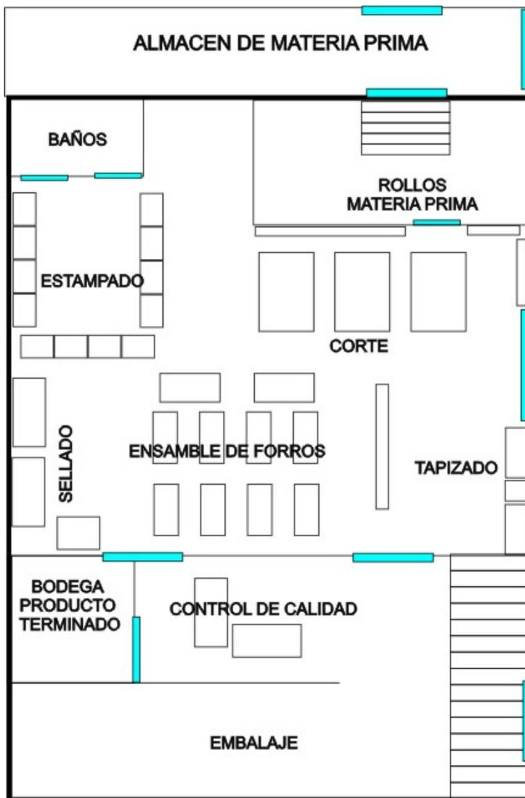
Según la investigación se planteo la redistribución de puestos de trabajo en esta sección, se cambio de lugar la sección de corte por la sección de ensamble.
