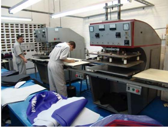
fig 61 maquinas de sellado
