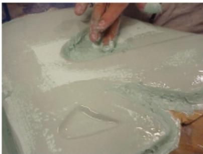
Se utiliza gel coat para garantizar que el molde copie los mas pequeños detalles que tiene el modelo final.
