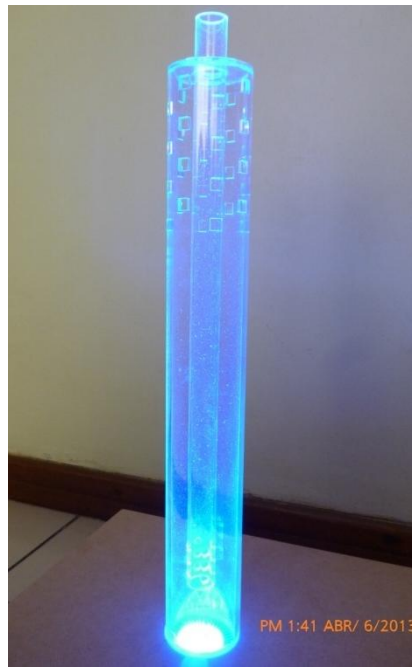
Figura 43. Ancla Poorboy con puertos de entrada cuadrados
