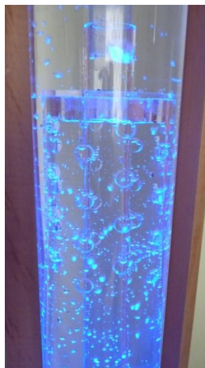
Figura 46. Prueba del prototipo de ancla de gas, perfil de orificio circular
