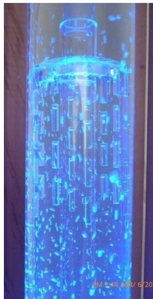
Figura 48. Prueba del prototipo de ancla de gas, perfil de Orificio Rectangular
