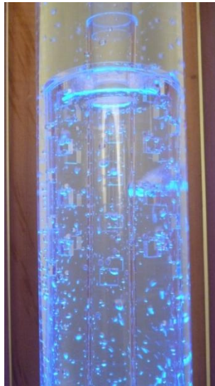
Figura 47. Prueba del prototipo de ancla de gas, perfil de orificio cuadrado
