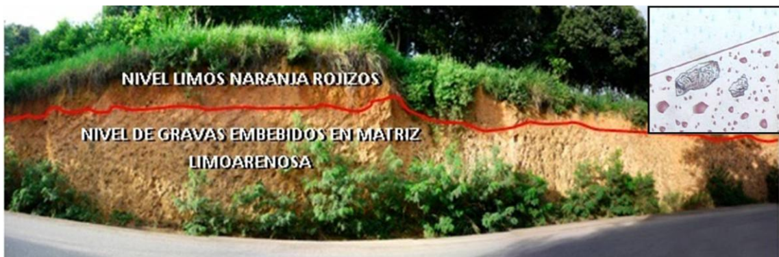
Figura 80. Contacto entre niveles de limos rojizos con gravas embebidas en matriz limoarenosa de color naranja. Afloramiento costado este de la Avenida El Papa hacia el Terminal de Transporte.
