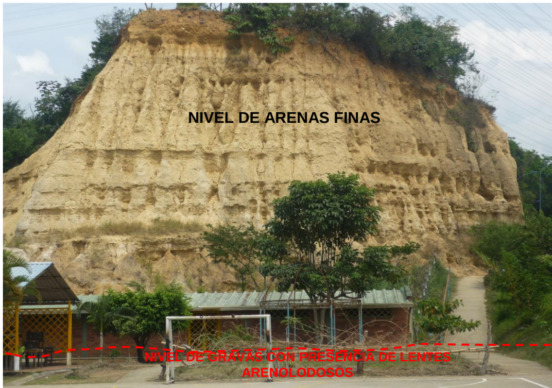
Figura 85. Posible contacto entre el nivel de arenas finas y nivel de gravas con presencia de lentes arenolodosos. Parque Sol de los Estoraques.
