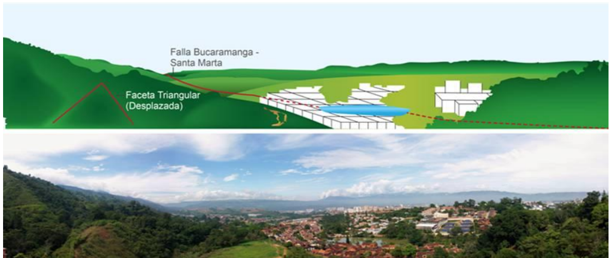
Figura 19. Fotografía y esquema en el que se muestran algunos rasgos de la falla de Bucaramanga, como lo son la charca de falla, una faceta triangular desplazada y uno de los trazos de esta falla.
