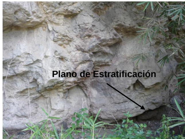
Figura 104. Imagen de detalle de plano de estratificación con dirección N10°E/20°SE.
