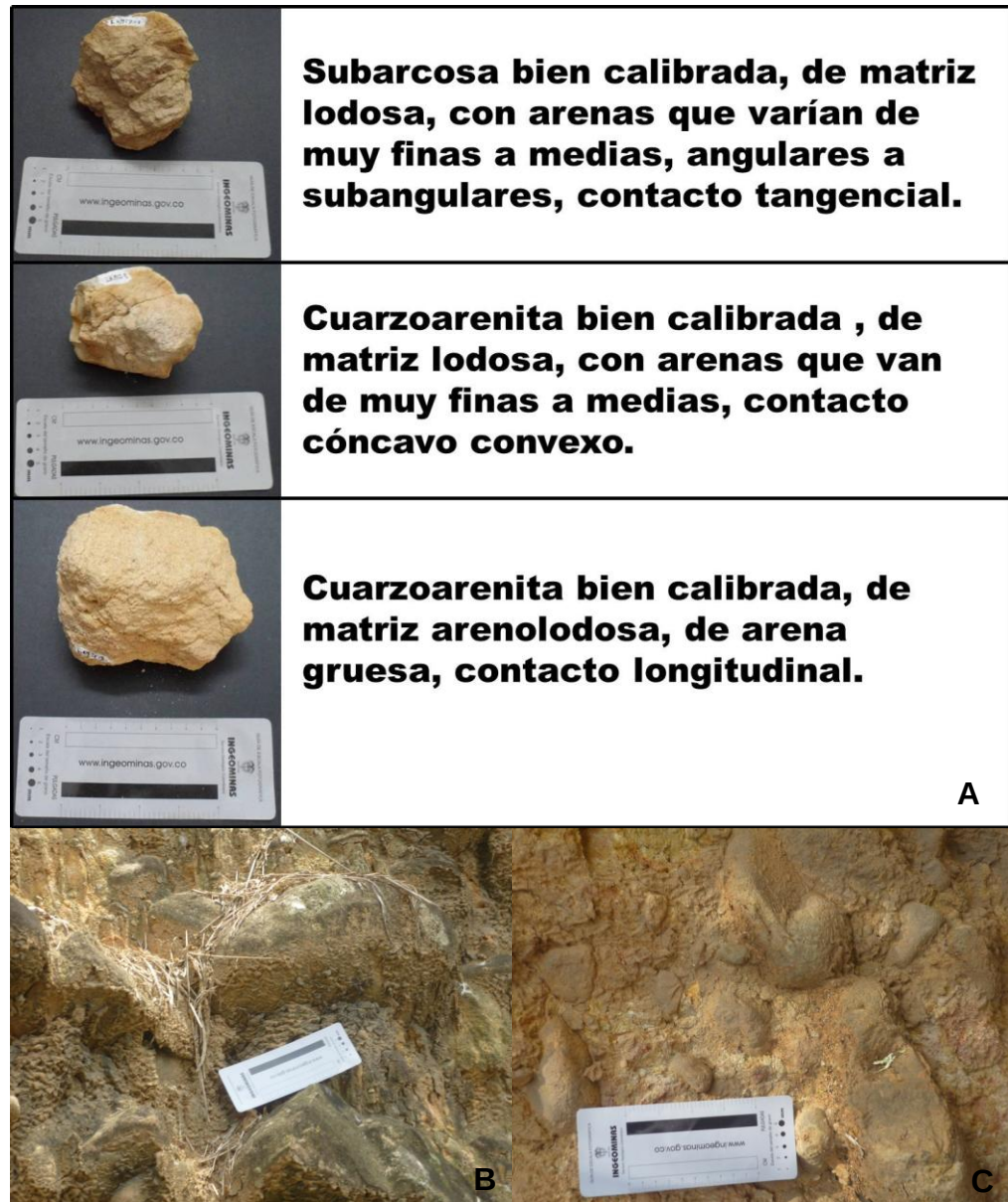
Figura 81. Descripción y tamaño de los clastos del nivel gravoso. A. Descripción de los clastos. B. Clastos de más de 30 cm. C. Clastos de menos de 10 cm a 20 cm. Afloramiento Avenida El Papa que conduce hacia el Terminal de Transportes.
