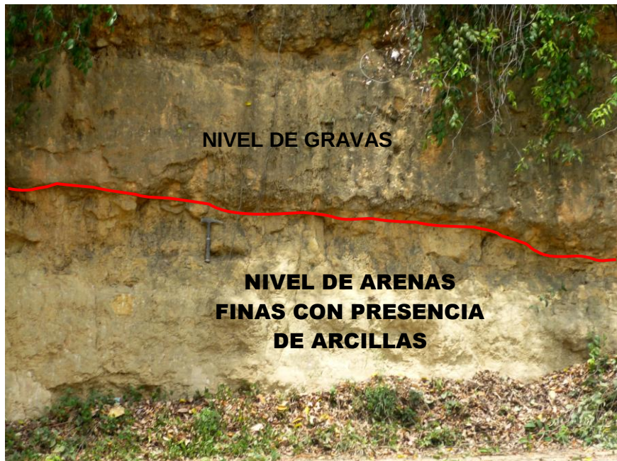
Figura 82. Contacto entre nivel gravoso y nivel de arenas finas con presencia de arcillas. Afloramiento sobre costado norte Avenida El Papa.
