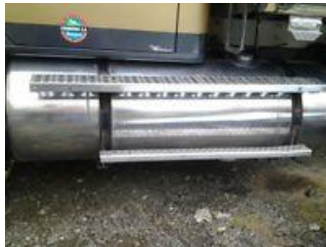
Figura 22. Tanque de Combustible
