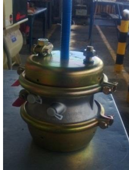
Figura 46. Cámara de seguridad
