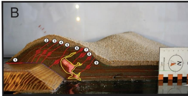
Figura 27. Corte transversal B del experimento CS_A_03, las fallas en el modelo son enumeradas de 1-9, en amarillo es delimitada la capa viscosa. Nótese el emplazamiento del material viscoso a lo largo de los planos de las fallas 6, 8 y 9.
