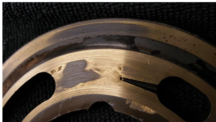
Figura 11. Daños por cavitación en una bomba de engranajes externos. Fuente: Solorzano, R. (2016, 13 junio). Cavitación en sistemas hidráulicos. Hydraulics & Pneumatics. https://www.hydraulicspneumatics.com/hp-espanol/articulo/21886592/cavitacin-en-un-sistema-hidraulico .
