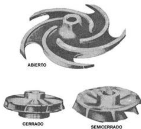
Figura 7. Rodete de bomba centrífuga. Fuente: www.ingenierocivilinfo.com
