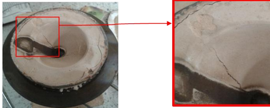
Figura 9: Revestimiento y modelo del refractario, granulometría pasante malla #200, a:p 55:100 y velocidad de agitación a 647 rpm después de ser sometido al tratamiento térmico.
