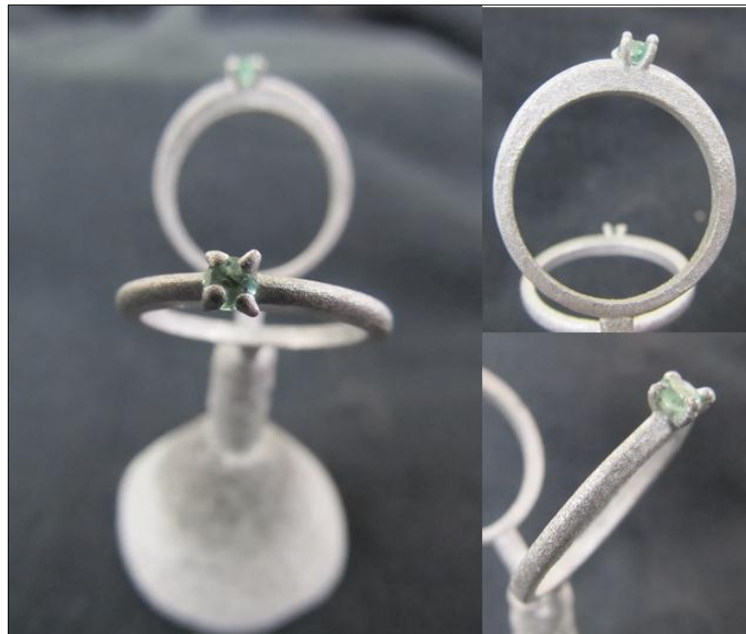
Figura 20: Resultado obtenido en la fundición final con pre-engaste de esmeraldas M5.
