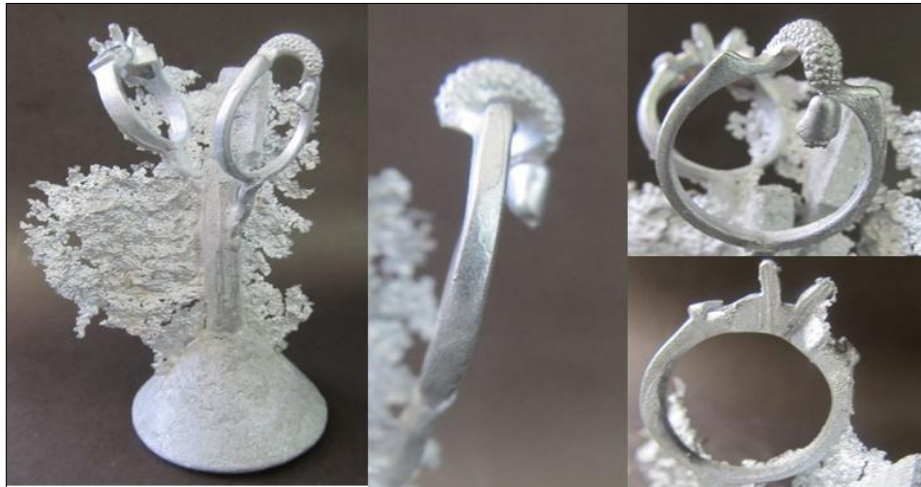
Figura 15: Resultado obtenido en la tercera fundición preliminar M3.
