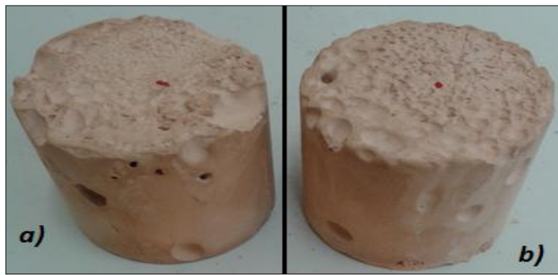
Figura 6. Probetas elaboradas para la composición refractaria 85/15 a) malla #140, b) malla #200.
