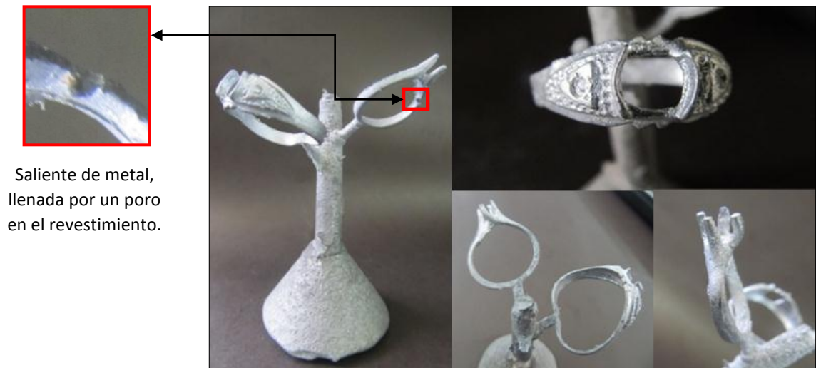
Figura 11: Resultado obtenido en la primera fundición preliminar M1.
