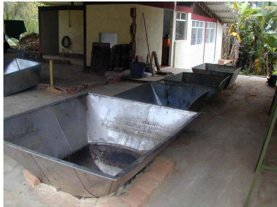
Fig. 4. Esquema de la paila semicilíndrica y vista de una de estas en una hornilla
