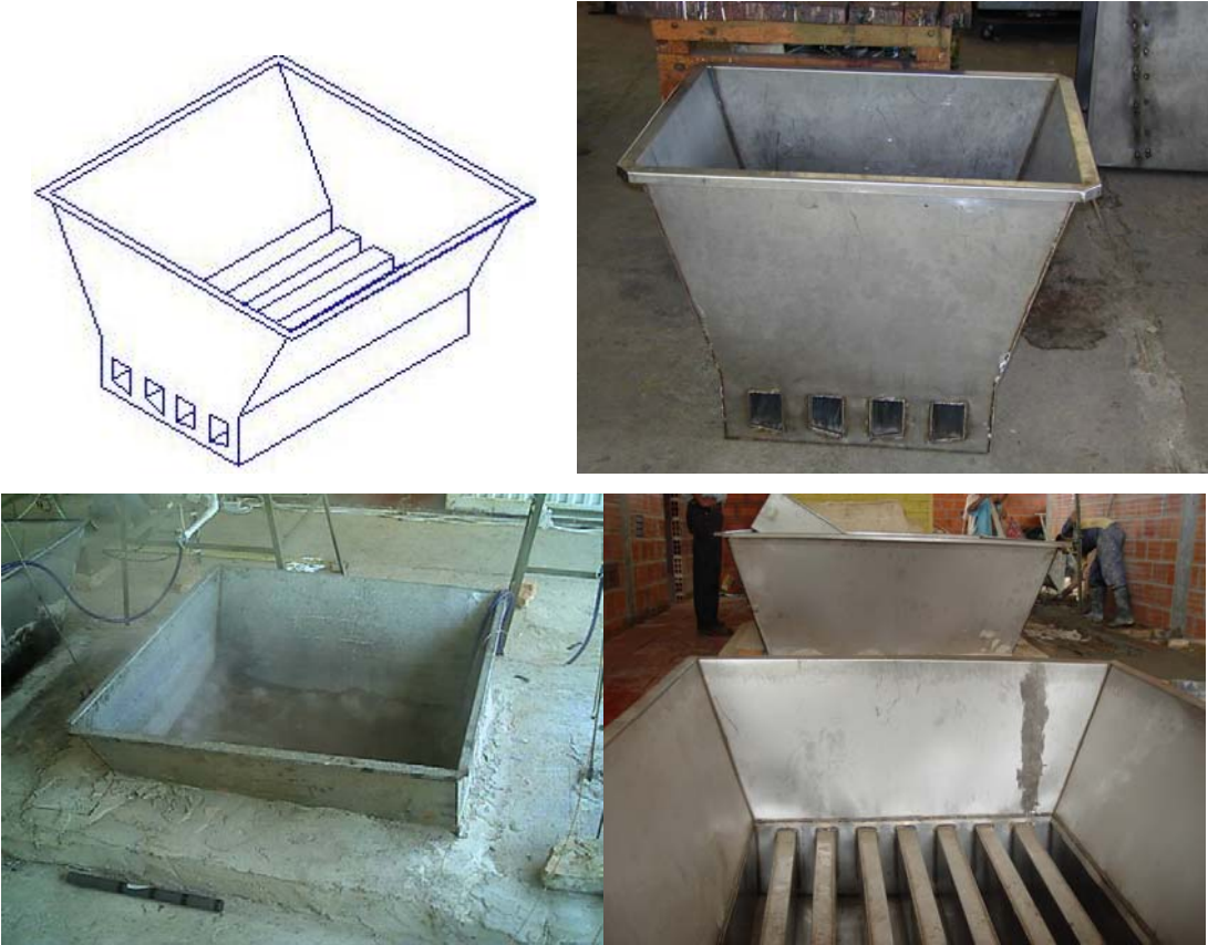
Fig. 7. Esquema de la paila pirotubular y diferentes vistas de la misma
