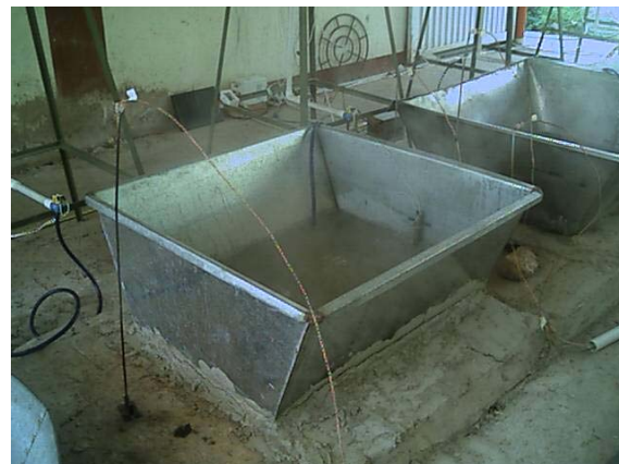
Fig. 5. Esquema de la paila plana y vista de su ubicación en una hornilla.
