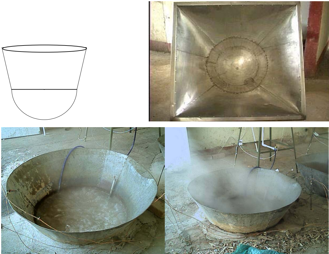
Fig. 3. Esquema de la paila semiesférica y diferentes vistas de la misma
