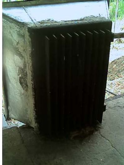
Fig. 6. Esquema de la paila plana aleteada y vista de las aletas en una paila comercial.
