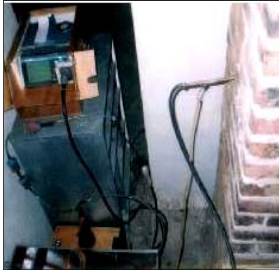
Fig. 12. Montaje experimental para el análisis de los gases de combustión
