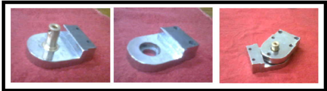
Figura 31. Piezas que componen la articulación del Codo del Robot SCARA 3 DOF.
