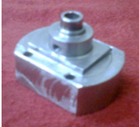
Figura 29. Cuerpo de la articulación del Hombro del Robot SCARA 3 DOF.
