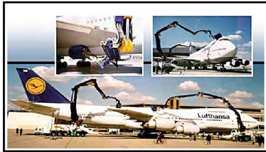
Figura 7. Actuadores Hidráulicos en un robot de limpieza del fuselaje de un Avión.
