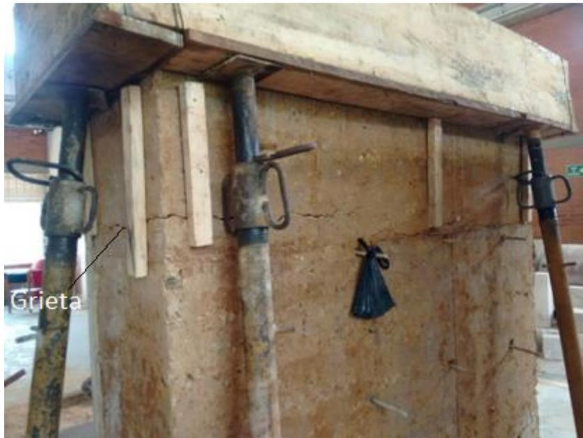
*Figura 64. Muro solo en tapia recortado para eliminar la zona desprendida por la grieta*
