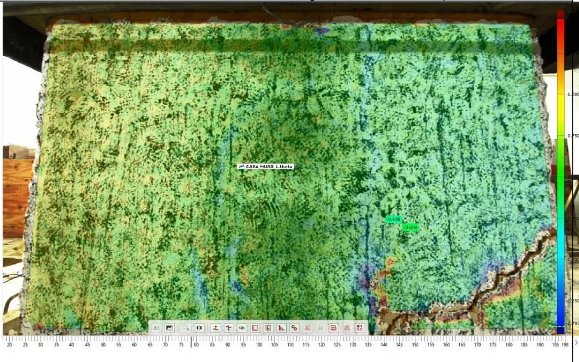
Figura 79. Estado del muro a  $3 \frac{1}{4}$  de ciclo. 93 s.
