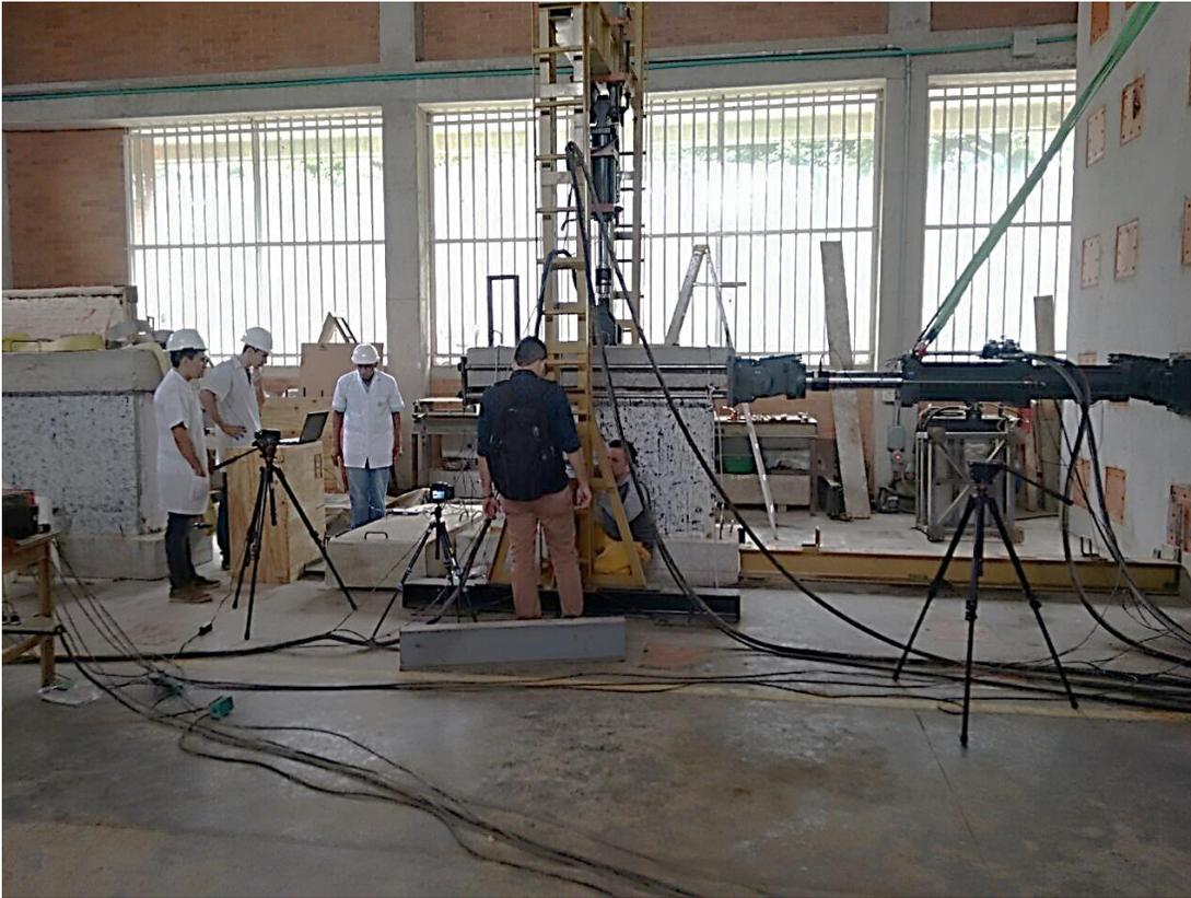
En la Figura 70 se observa la colocación de los sensores. Se colocó uno en la base a 35 cm del piso, otro a media altura, 70 cm del piso, y un tercero en la viga corona a 105 cm del piso.
