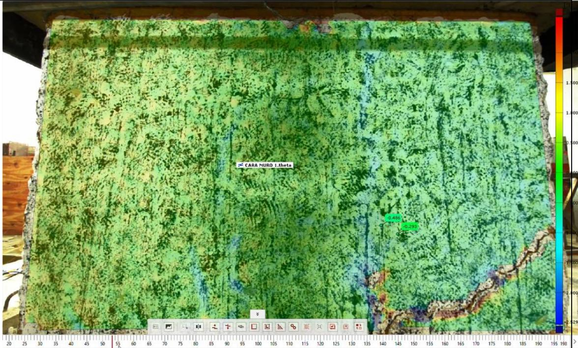
Figura 78. Estado del muro a  $2 \frac{3}{4}$  de ciclo. 78 s.
