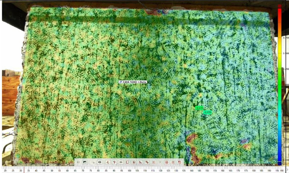
Figura 76. Estado del muro a  $1 \frac{3}{4}$  de ciclo. 48 s.
