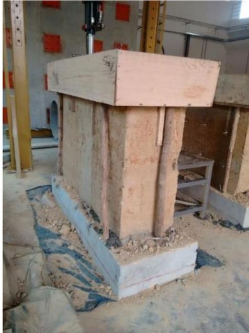
*Figura 65. Muro en tapia reforzado recortado para eliminar la zona desprendida por la grieta.*
