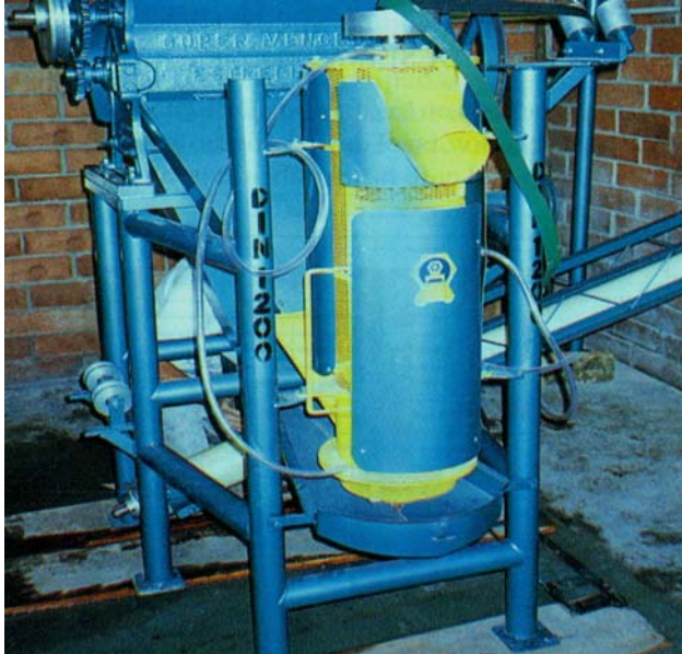
Figura 5. A la izquierda maquina desmucilaginadora y a la derecha tornillo sin fin encargado de la fuerza centrifuga y de la fricción contra las paredes.
