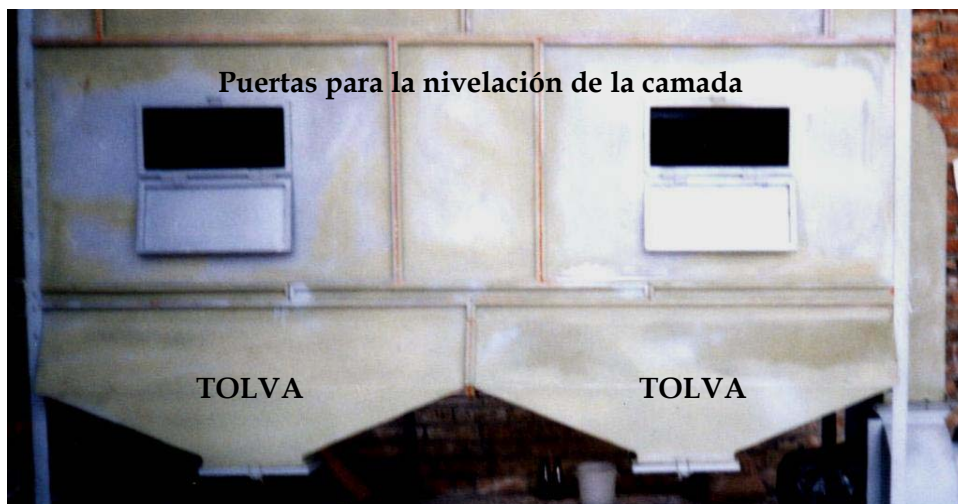
Figura 41. Tolvas para la descarga de café y compuertas para la nivelación de la camada.
