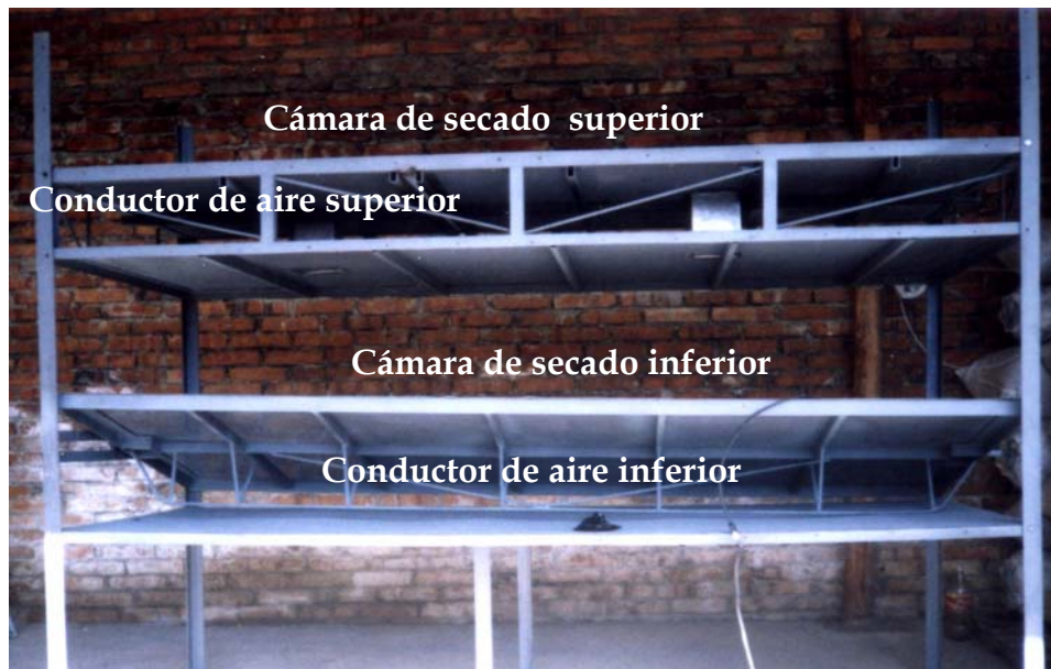
Figura 39. Cámaras de secado en la estructura.
