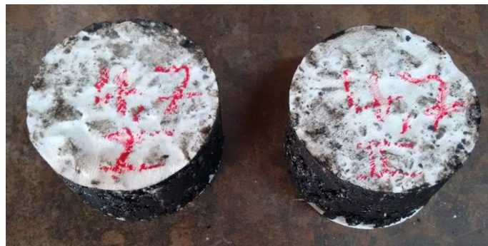
Figura 10. Probetas con contenido de asfalto del 4.7%
