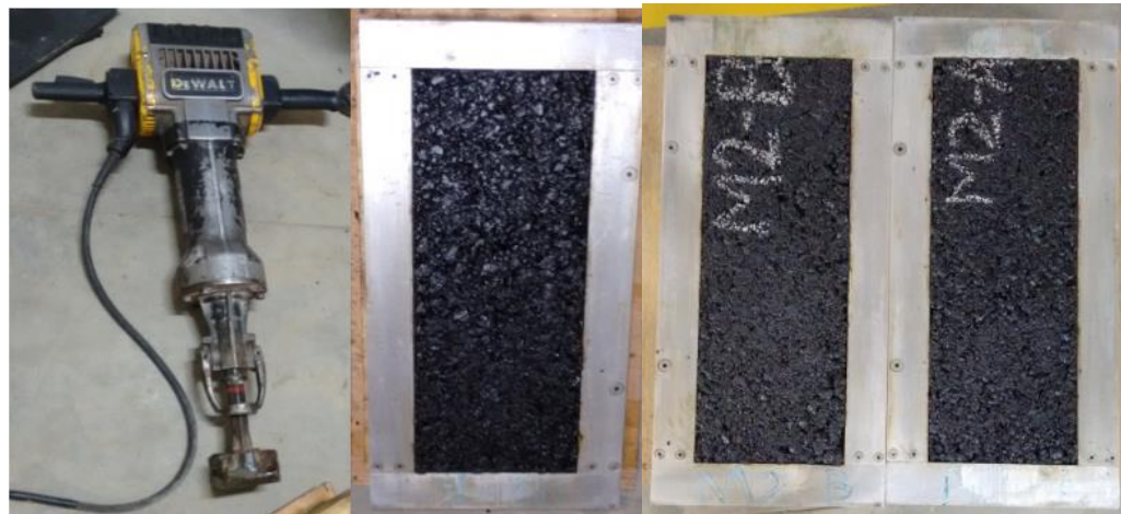
Figura 11. Compactación de probetas para la máquina de ahuellamiento.
