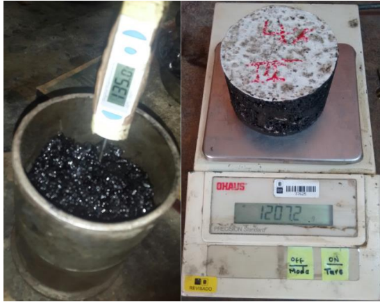
Figura 8. Elaboración probetas Marshall
