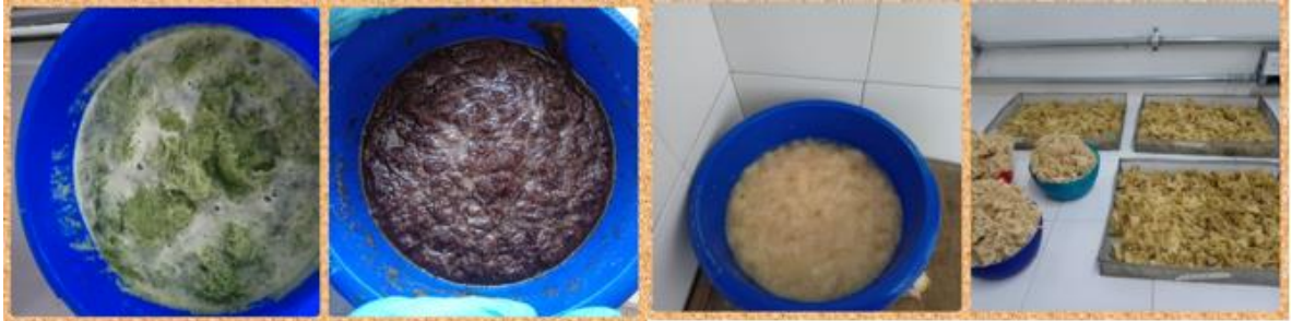
Figura 2. Procesamiento de las fibras de los subproductos del plátano. De izquierda a derecha: Licuado de los subproductos; tratamiento con NaOH; blanqueamiento con NaClO; Secado
