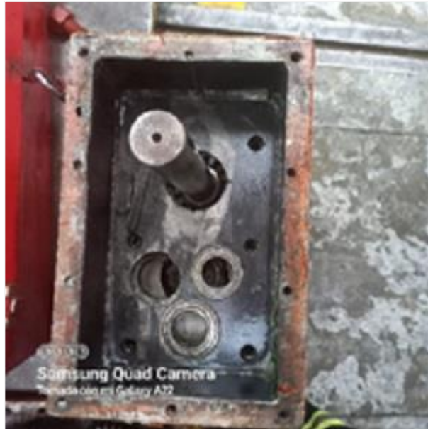
Figura 13. Deterioro de los alojamientos de los rodamientos
