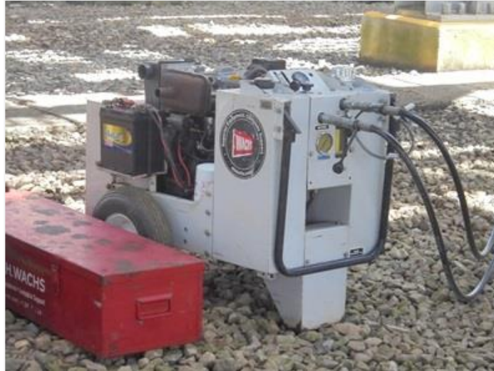
Figura 2. Máquina hidráulica para operación de la válvula
