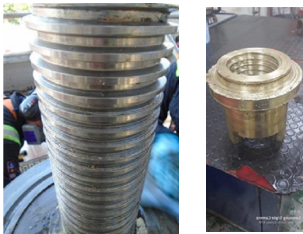
Figura 15. Vástago y tuerca sinfín dañados
