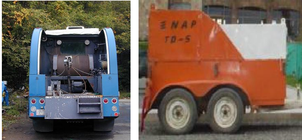
Figura 7-8. Varios sistemas transporte de carrete de guaya electrica (En camion y en remolque)
