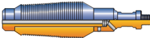
Figura 23. Limadores de tubería
