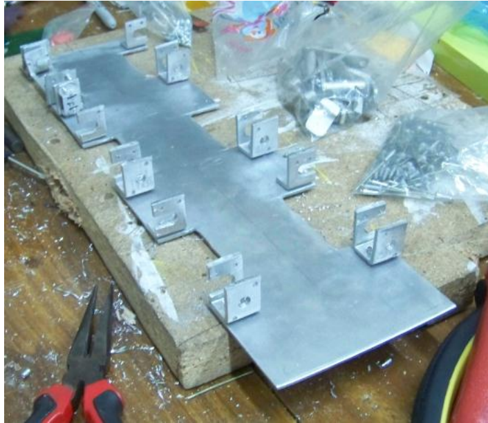
Figura 90. Estructura con Apoyos de hombro
