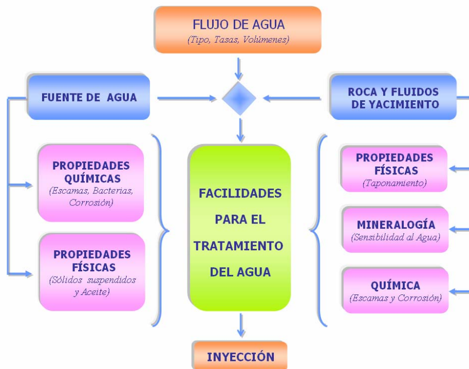
Figura 80. Estrategia para Seleccionar la Fuente de Agua y el Tipo de Tratamiento
