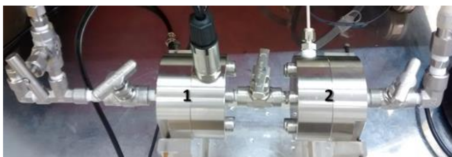
Figura 9. Sistema de doble compartimiento para sorción de dióxido de carbono. 1) Celda de carga del gas (CO 2 ); 2) Celda de muestra.
