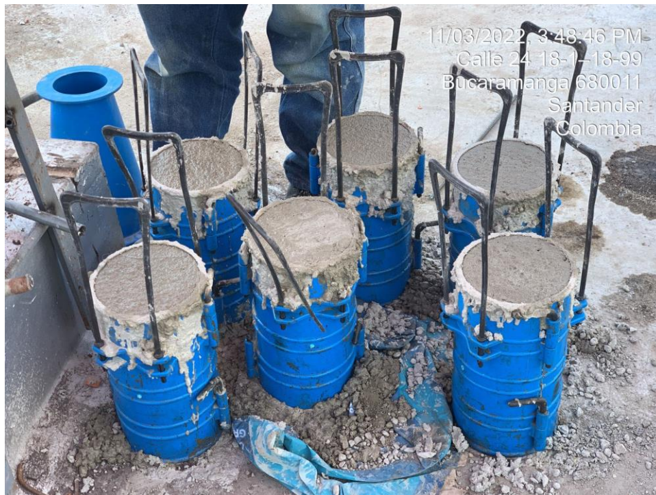
Figura 10. Toma de muestras de concreto.
