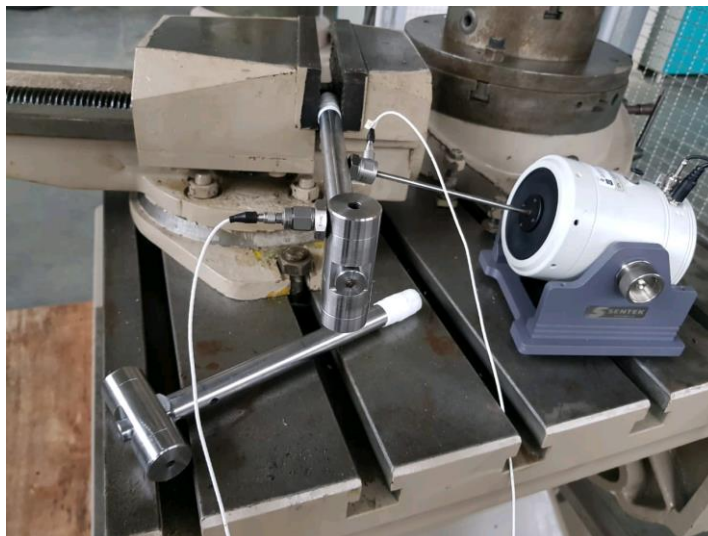
Figura 45. Montaje del hammer empotrado en un extremo mediante una prensa mecánica, en las instalaciones de la escuela de ingeniería mecánica de la UIS.
