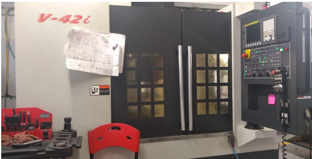
Figura 32. Fase del maquinado de la cabeza en la Fresadora de cuatro ejes de RAMBAL.
