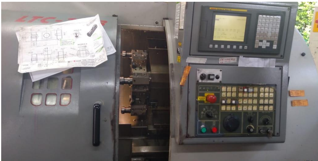
Figura 31. Fase de maquinado de la cabeza del hammer en el Torno CNC.
