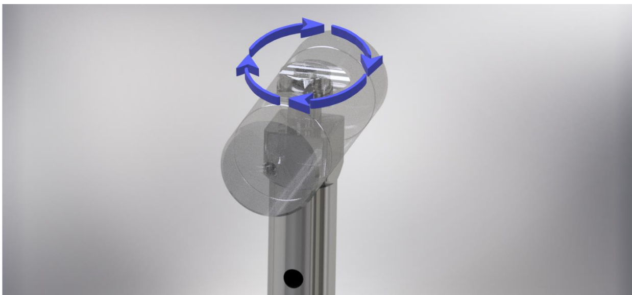
Figura 19. Caja cuadrada del mango para evitar torques en unión cabeza- mango, representados con la flecha azul.
