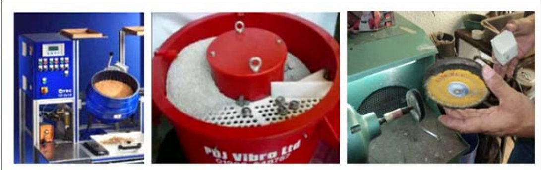
Figura 20 Lijado, pulido y abrillantado de las piezas
