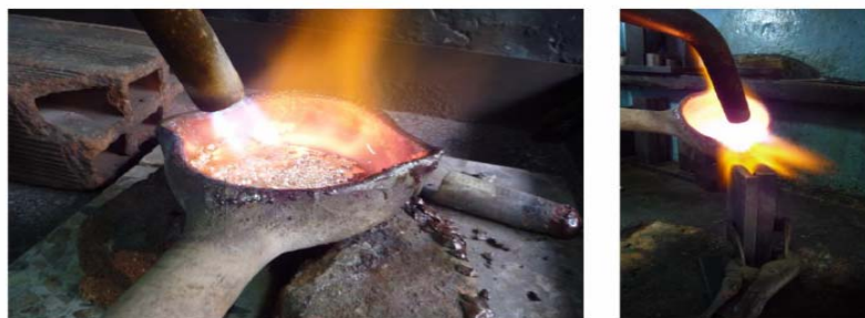
Figura 11 Fundición y transformación de la plata
