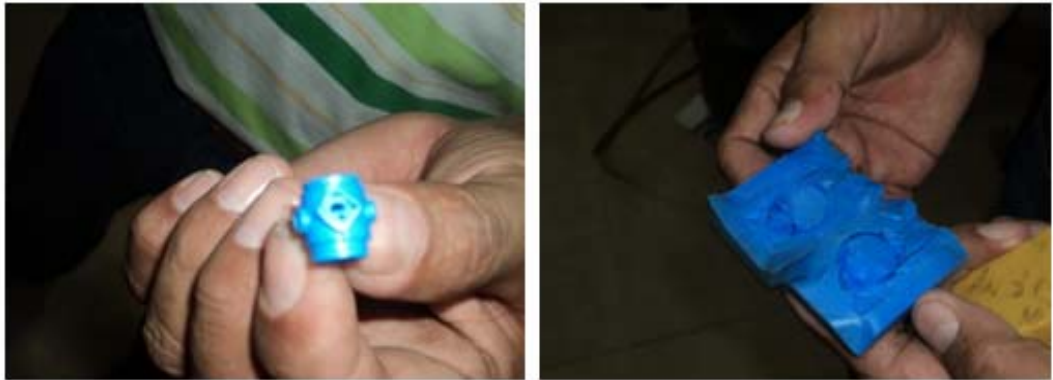
Figura 22 Matriz original para elaboración de los moldes en caucho
