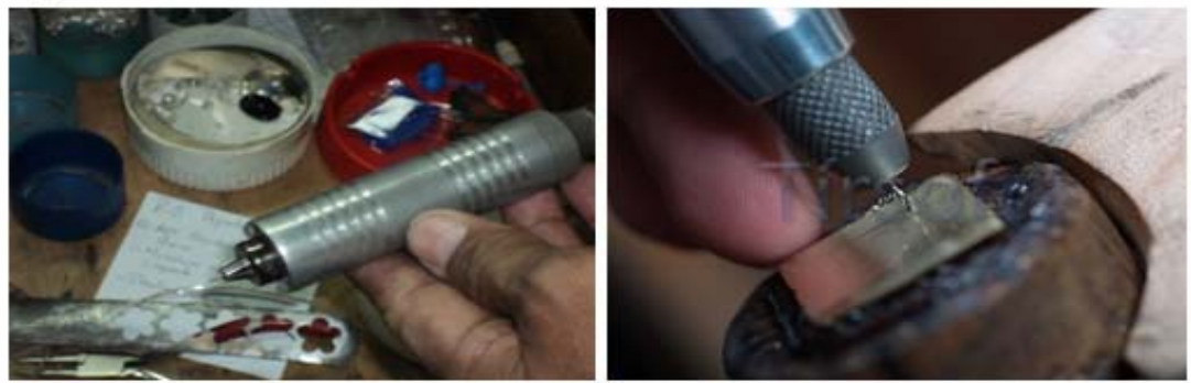
Figura 18 Perforado de las esferas
