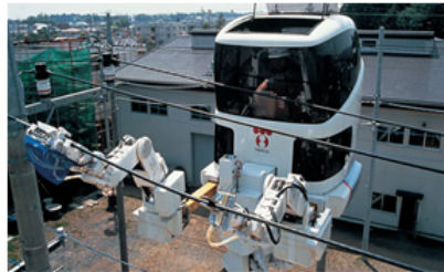
Figura 15.23: Robot tele-operado para manejo de líneas de alta tensión
