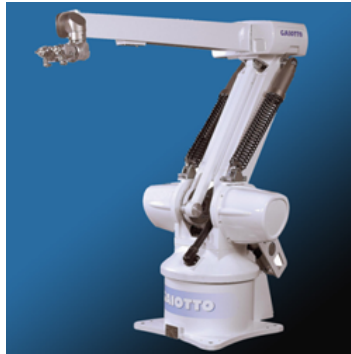
Figura 14.5: Robot Gaiotto. Ejemplo de robot con programación de guiado pasivo directo
