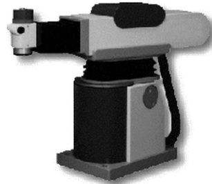
Figura 7.4: Robot RT33 -Configuración cilíndrica
