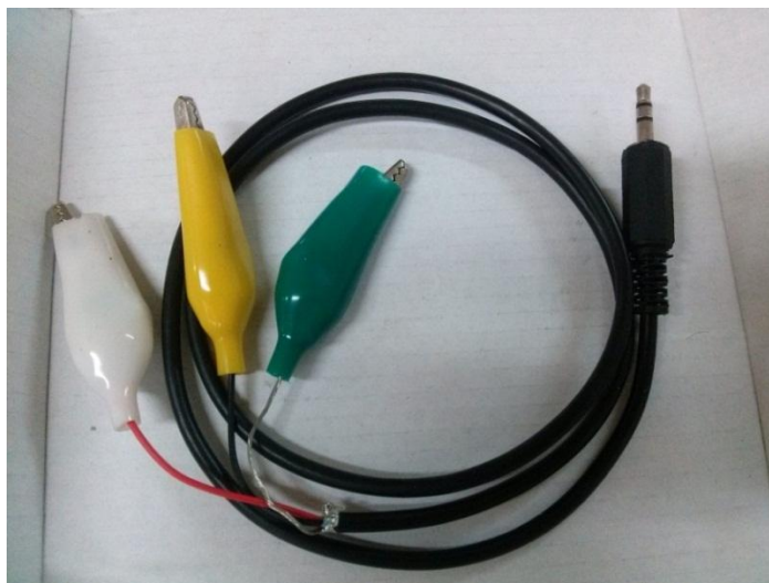
Figura 18. Cables para la conexión de la celda electroquímica
