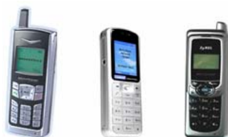
Figura 12. Ejemplos de teléfonos Wifi de VoIP
