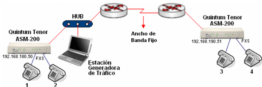
Figura 34. Repercusiones del tráfico en la red sobre la calidad de voz. Caso 1: Colisiones en la red
