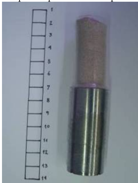
Figura 38. Adaptación para corte de las probetas de 22mm
