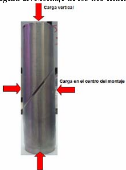
Figura 45. Montaje de los dos endcap
