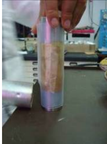
Figura 55. Cierre de la segunda chaqueta termoencogible
