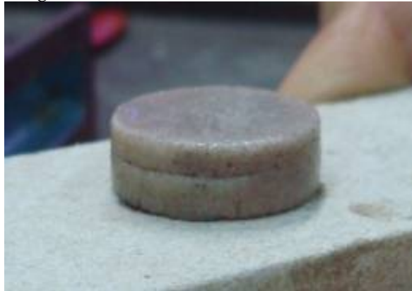
Figura 85c. Muecas en la muestra de roca
