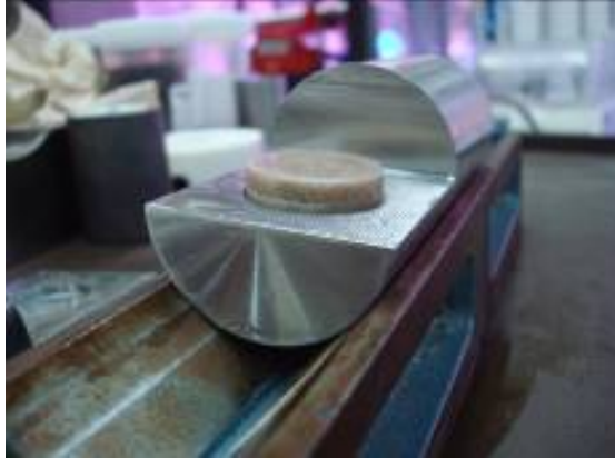
Figura 85b. Endcap con la muestra de roca saturada
