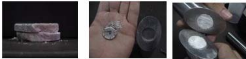
Figura 63. Muestra de roca fallada
