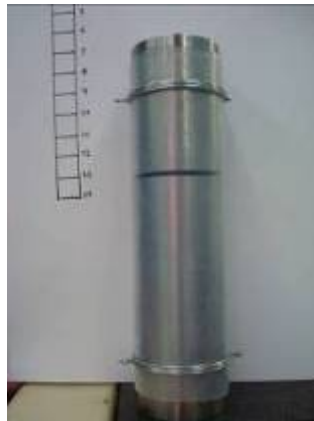
Figura 56. Ubicación de los sellos de alambre en el montaje.
