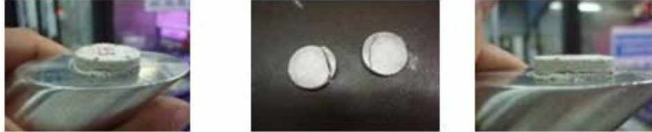
Figura 77. Muestra de roca fallada
