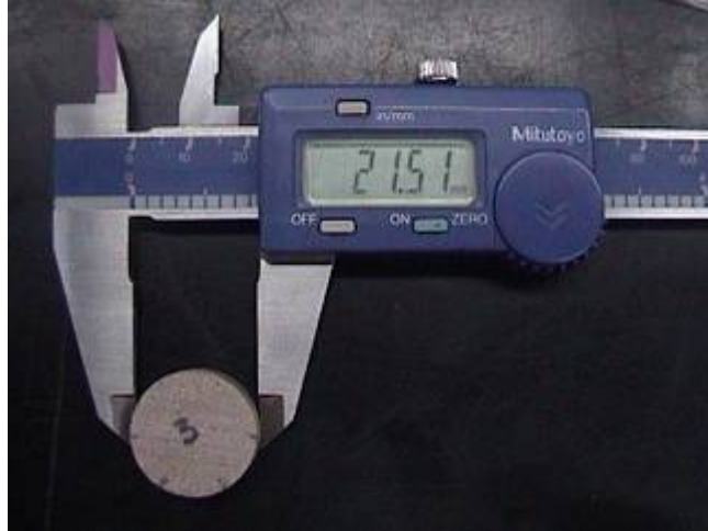
Figura 42. Medida del diámetro de la muestra en los 3 diferentes puntos
