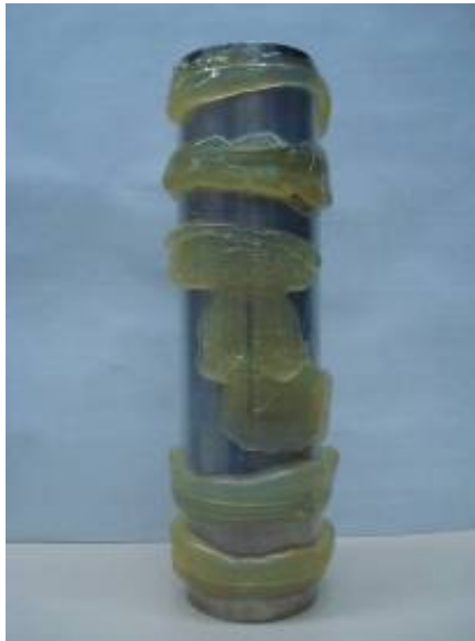
Figura 57. Sellos de silicona sobre el montaje
