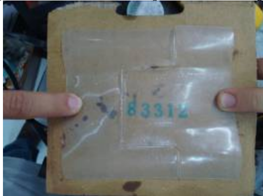
Figura 85a. Falla de la chaqueta termoencogible
