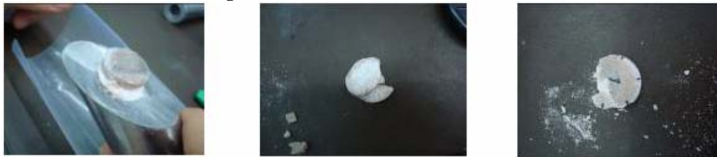
Figura 61. Muestra de roca fallada
