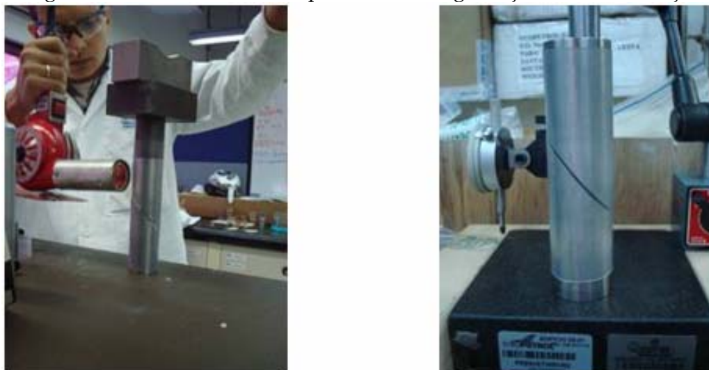
Figura 46. Reducción de la chaqueta termoencogible ajustando el montaje.
