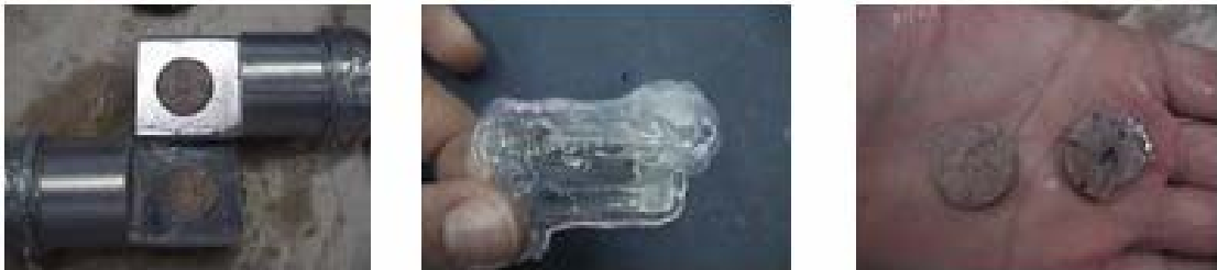
Figura 81. Muestra de roca fallada
