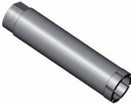
Figura 33. Diseño de broca hueca diamantada para extracción de probetas
