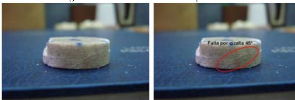
Figura 90. Muestra de roca fallada por cizalla.
