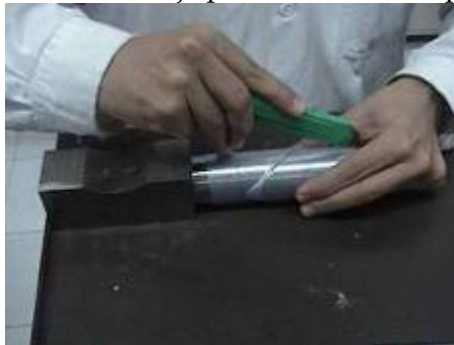
Figura 48. Disposición del montaje para retirar la chaqueta termoencogible
