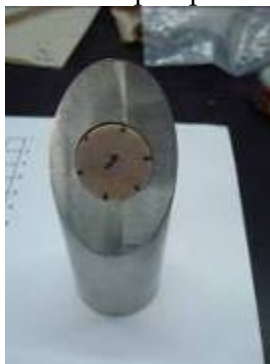
Figura 44. Disposición del endcap superior con la muestra de roca
