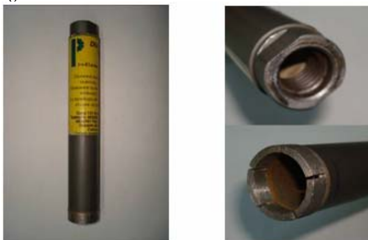
Figura 35. Broca diamantada de 22mm de diámetro interno.
