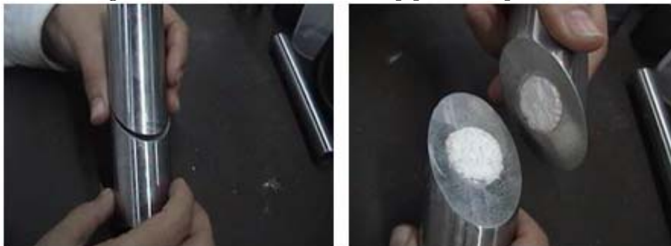
Figura 50. Ubicación de los endcap para su separación.
