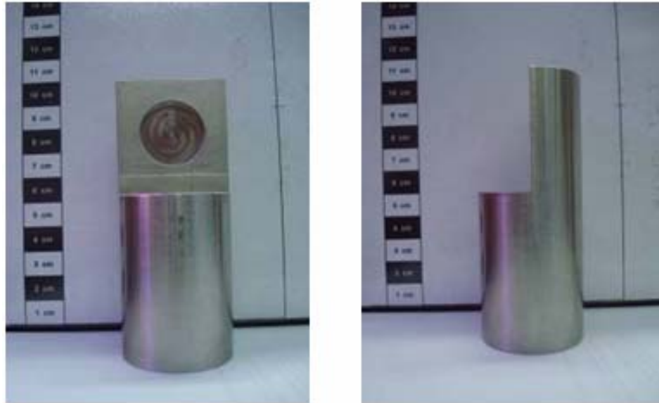
Figura 29. Vista frontal y lateral del endcap de 90°.
