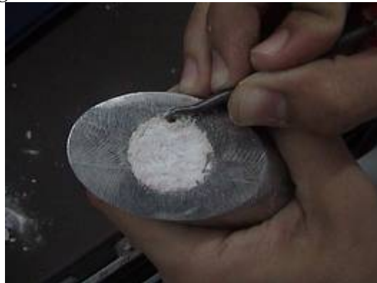
Figura 51. Remoción de material de la muestra
