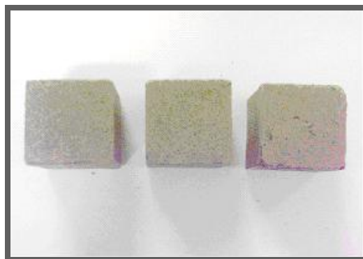
Figura 15. Falla de probetas con 40% de colas en arena.
