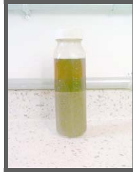
Figura 3. Determinación de materia orgánica en arena
