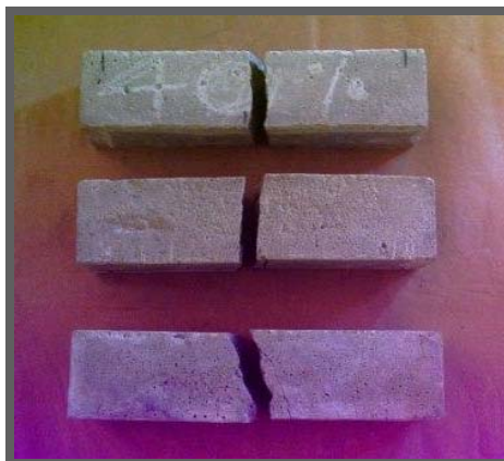
Figura 20. Falla de probetas con 40% de colas en arena
