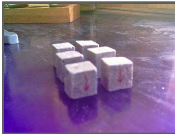
Figura 5. Muestras utilizadas en el ensayo de porosidad.
