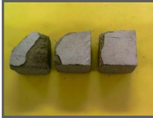
Figura 16. Deterioro de probetas con 60% de colas en arena
