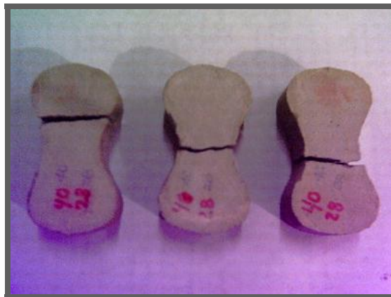
Figura 19. Falla de probetas con 40% de colas en arena.
