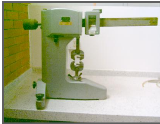
Figura 3. Montaje ensayo de Tracción
