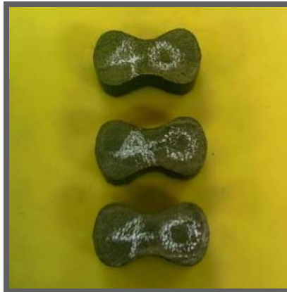
Figura 17. Probetas para ensayo de tracción
