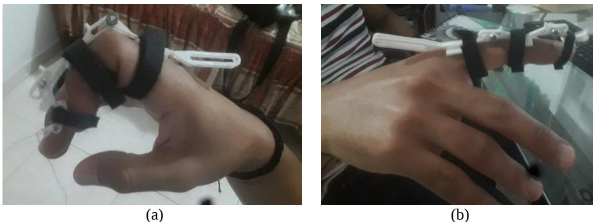
Figura 23. Segundo ensamblaje del dedo índice (a) flexión. (b) tensión.
