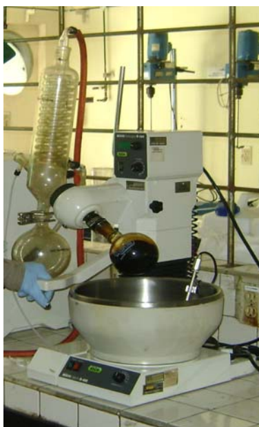
Fotografía 3. Equipo de Rotoevaporación Empleado.
