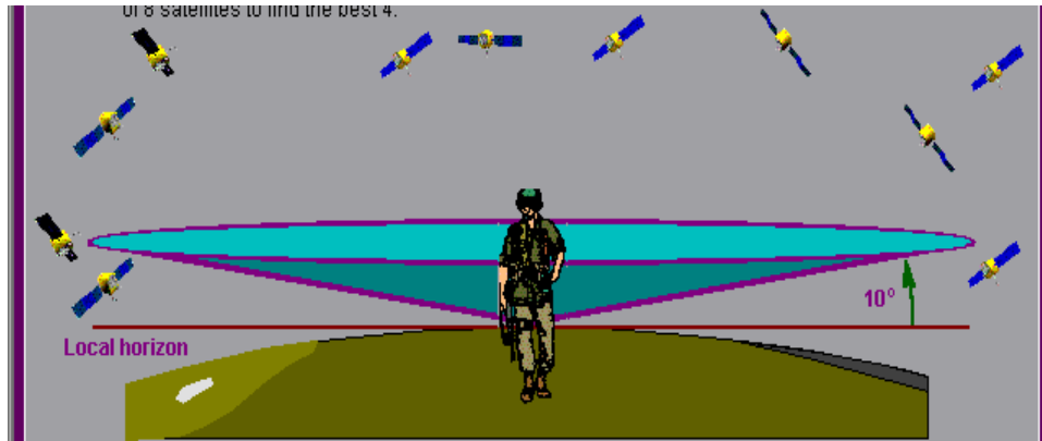
Figura 133. Ángulo de enmascaramiento
