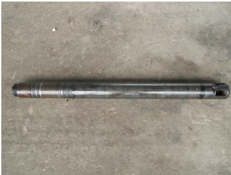
Figura 8. Válvula de seguridad de fondo instalada en Caño Limón.
