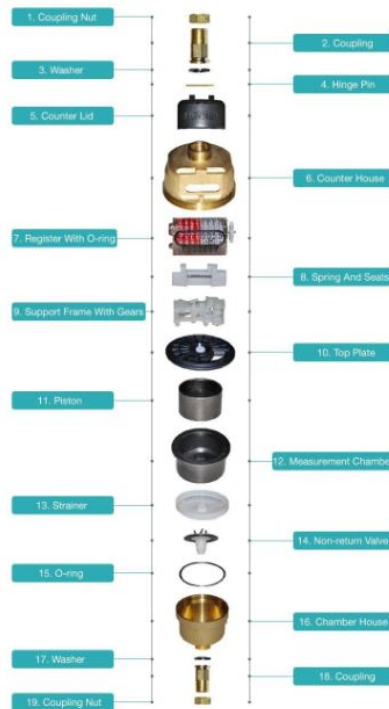
Figura 5. Despiece del contador de agua modelo R200.
