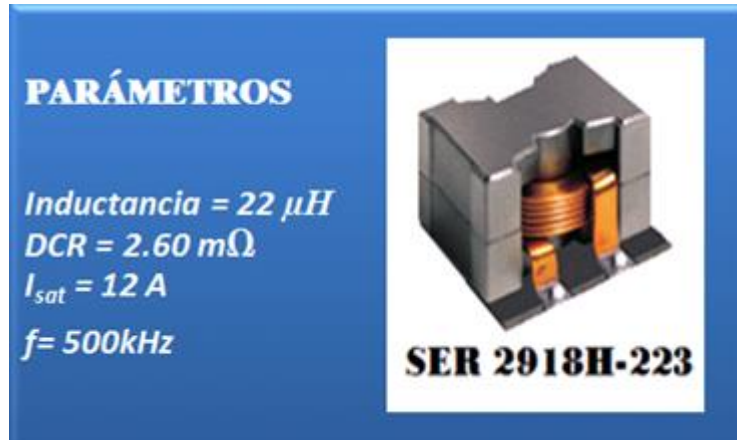
Figura 31. Características principales Bobina SER2918H-223
