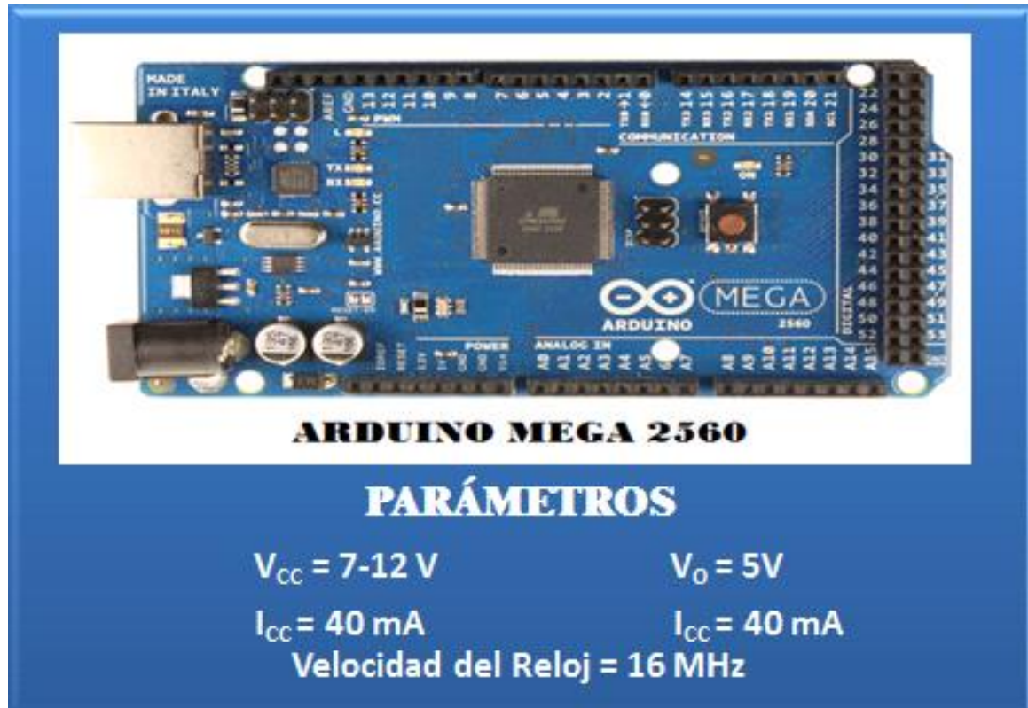
Figura 24. Parámetros importantes de la Tarjeta Arduino MEGA 2560
