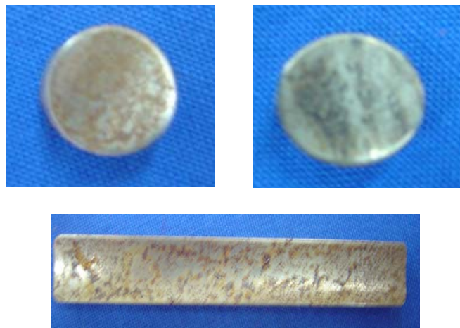
Figura 35. Formación de capas superficiales de productos de corrosión sobre el electrodo de acero al carbono en una solución de NaCl al 3% saturada con CO 2 /H 2 S
