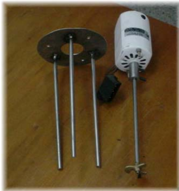
Figura 10. Desviadores verticales y agitador eléctrico
