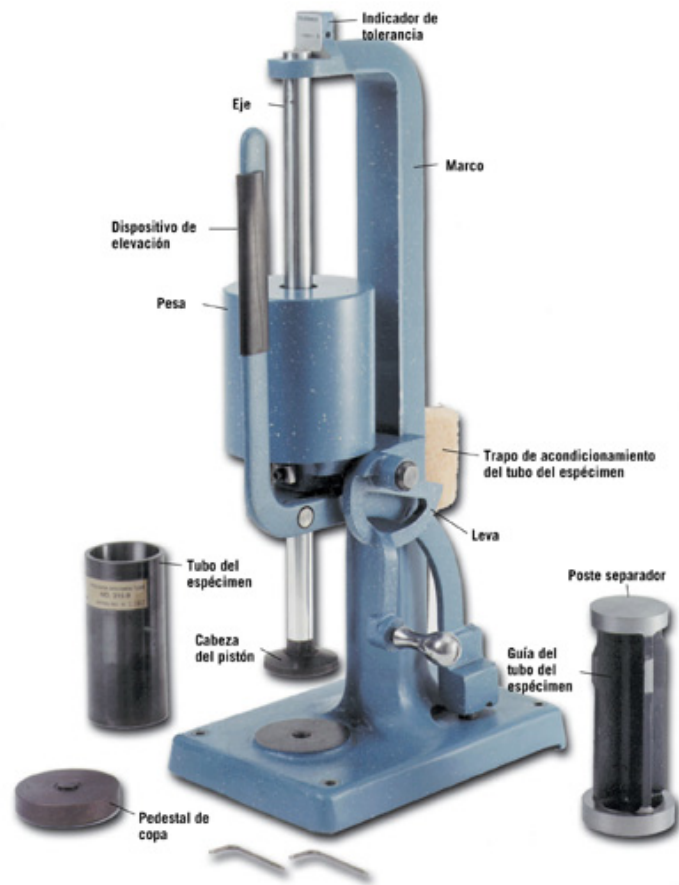
Fig. 1. Compactadora típica de arena con sus partes indicadas.
