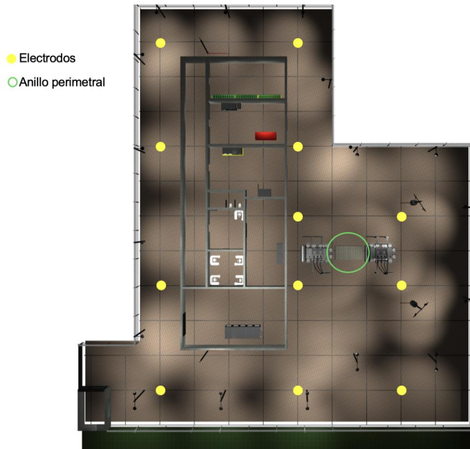
Figura 9. Vista superior de la malla de puesta tierra.
