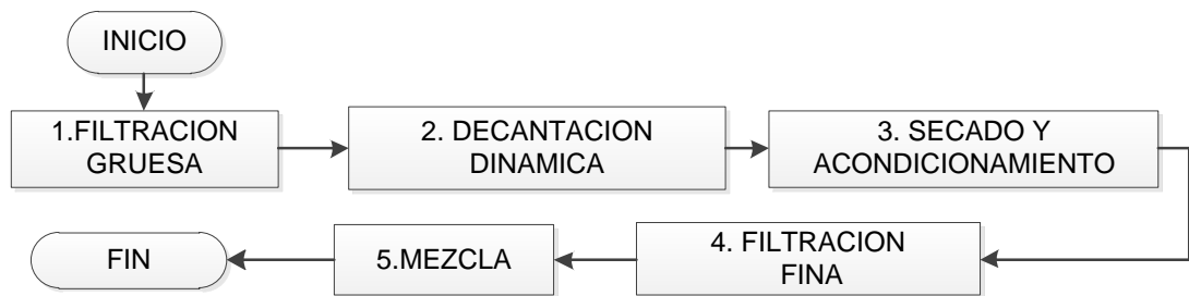
Figura 8. Proceso de Re-refining.
