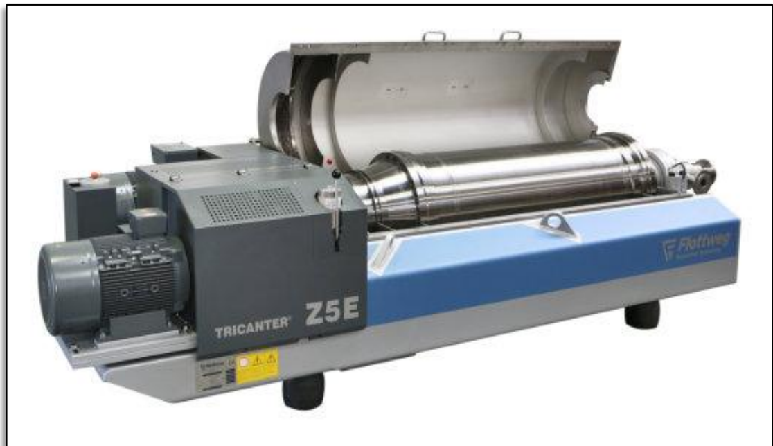
Figura 12. Tricanter, equipo de separación de tres fases.
