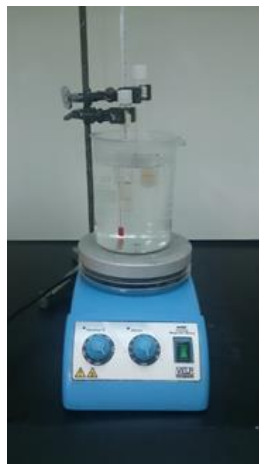
Figura 13. Montaje reacción de metanolisis
