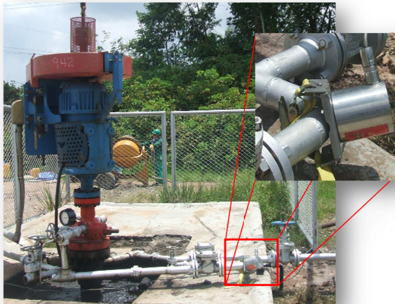
Figura 8.8. Localización del dispositivo ultrasónico de monitoreo.
