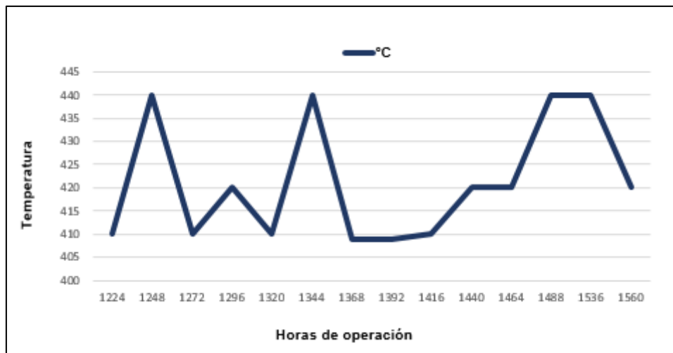
Figura 29. Temperatura de gases de Escape en las últimas 300 horas
