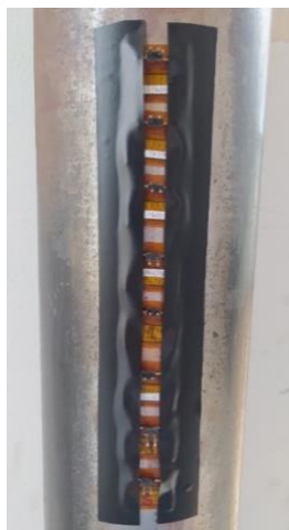
Figura 31. Montaje de los piezo-actuadores ubicados de forma vertical.
