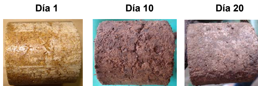
Figura 26. Cambio del aglomerado expuesto al sol y al agua lluvia
