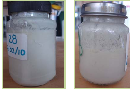
Figura 12. Emulsiones 28 y 30 respectivamente, preparadas usando como tensioactivo lecitina de soya y agregando directamente el poliestireno en su preparación
