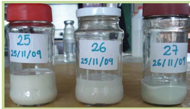
Figura 11. Emulsiones preparadas usando como tensioactivo lecitina de soya y agregando directamente el poliestireno en su preparación
