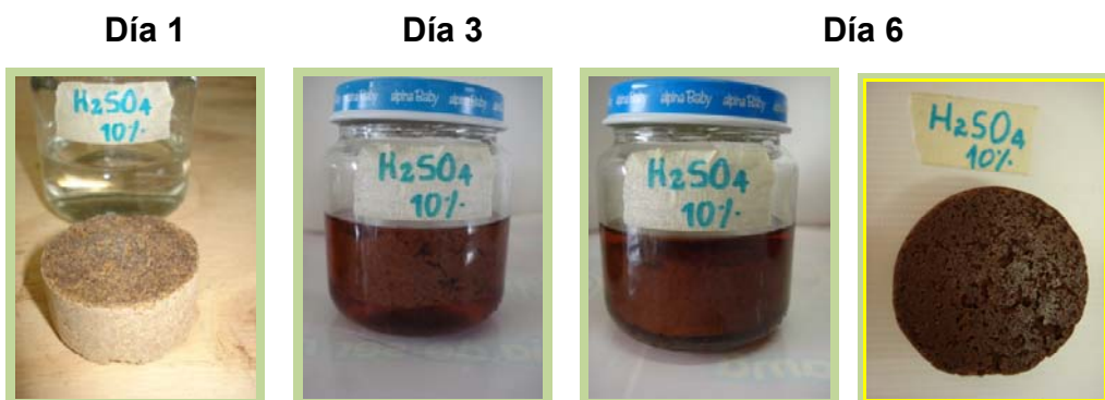
Figura 23. Cambio del aglomerado expuesto a \text{H}_2\text{SO}_4 al 10%
