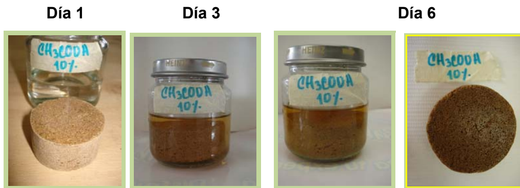
Figura 21. Cambio del aglomerado expuesto a \text{CH}_3\text{COOH} al 10%
