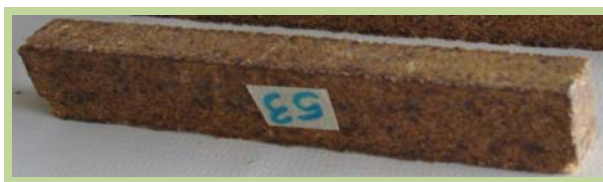
Figura 38. Probeta utilizada para prueba mecánica de impacto
