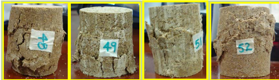
Figura 37. Probetas 48, 49, 51 y 52 después de realizada la prueba de compresión
