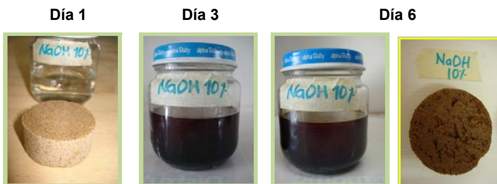
Figura 20. Cambio del aglomerado expuesto a NaOH al 10%
