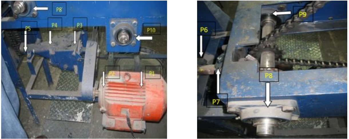
Figura 60. Puntos en la maquinas de pines para medición
