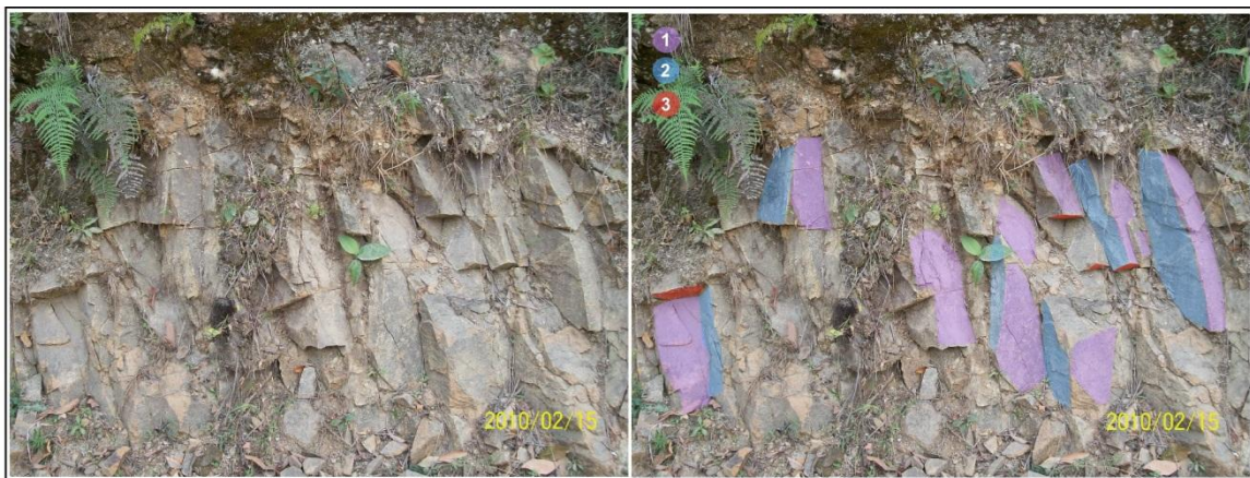
Foto 11: Afloramiento del Lacolito de Atanquez, a la derecha se muestran tres de las familias de discontinuidades.
