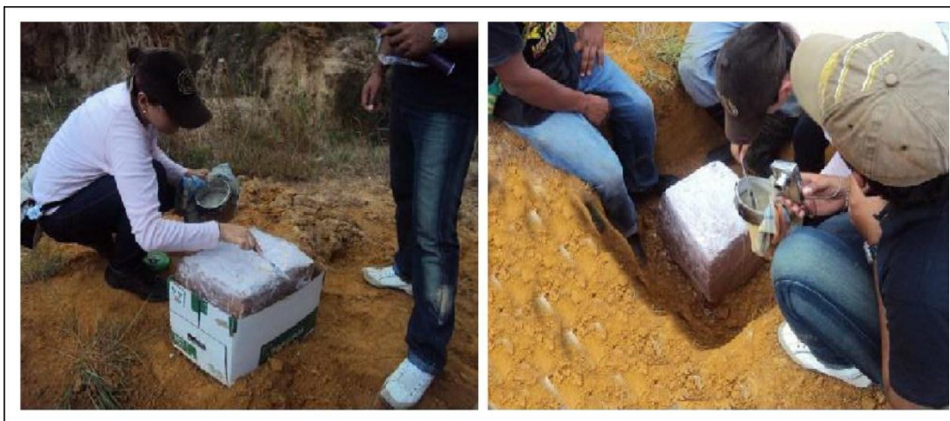
Foto 31: Parafinar totalmente la muestra
