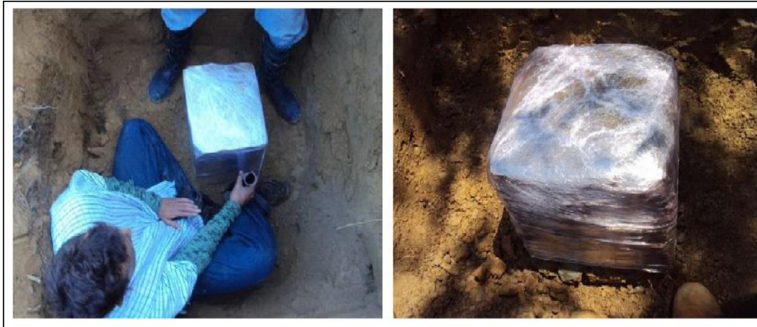
Foto 30: Envolvimiento de la muestra en papel película
