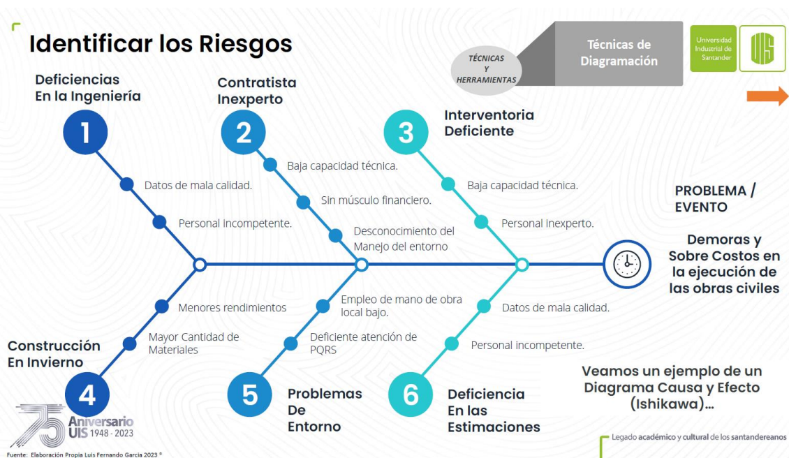
Figura 3. Ejemplo de Identificación de Riesgos por Diagrama de Causa – Efecto
