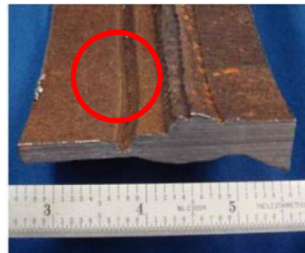
G. Corrosión por aminas. (American Petroleum Institute, 2011)
