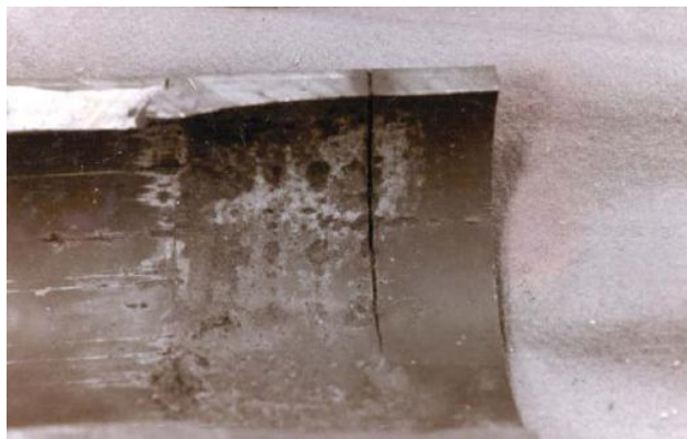
FIGURA 11. Corrosión bajo esfuerzo.
