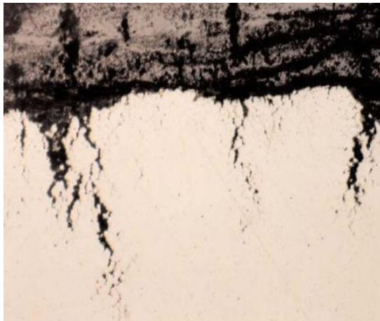
FIGURA 10. Corrosión intergranular en tuberías
