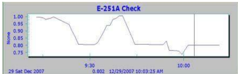
FIGURA 21 Pruebas SAT con probetas CORROSOMETER. Fuente
