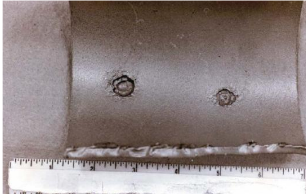
FIGURA 14. Efecto terraza, ataque por bacterias NALCO “Corrosión en la Industria Petrolera”. U.S.A. Texas 2007. Pág.28, 48, 49.
