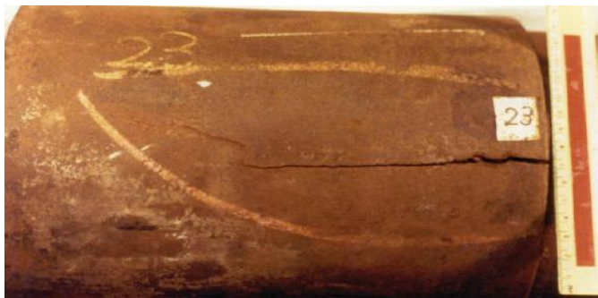
FIGURA 12. Fragilización por hidrógeno
