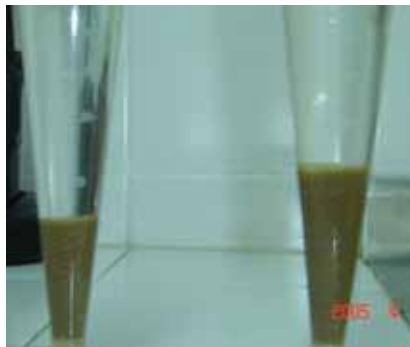
Figura 14. Determinación del volumen de lodos producidos utilizando conos Imhoff.
