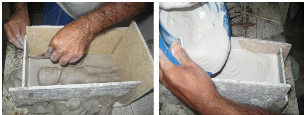
Figura 21: Ensamble de las paredes y llenado del molde Fotografías: Andrés Julián Saavedra Pinto, Septiembre 2011
