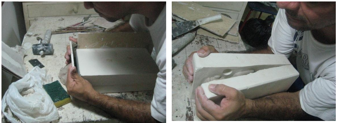
Figura 22: Fraguado del yeso y apertura del molde Fotografías: Andrés Julián Saavedra Pinto, Septiembre 2011
