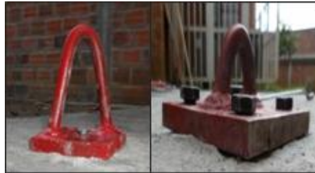
Figura 2. Platinas de extracción de anclajes
