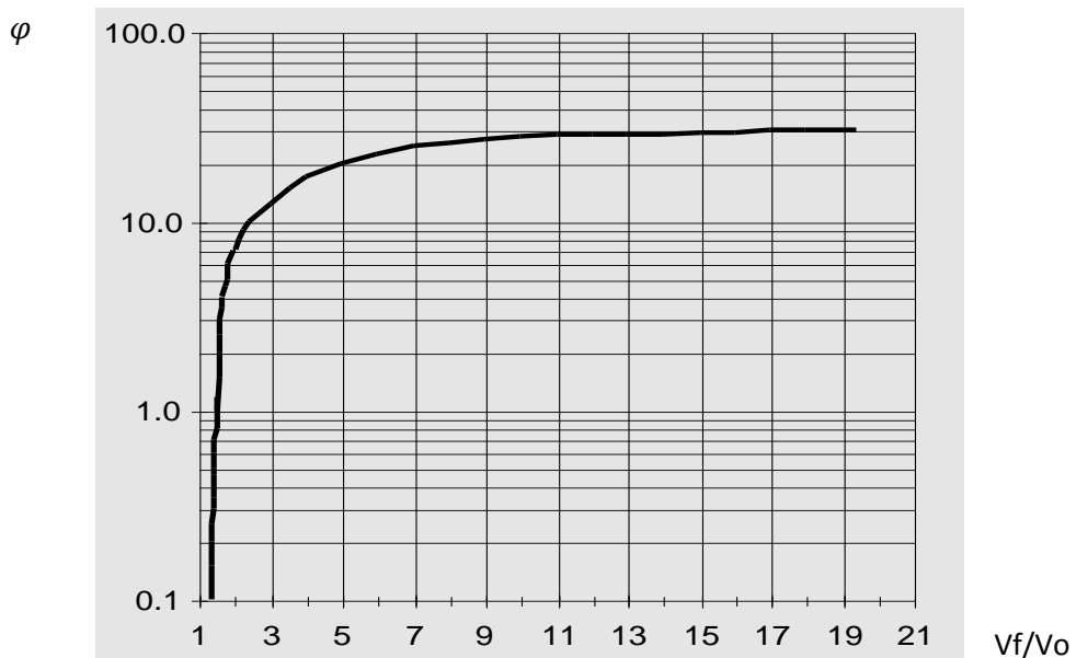
Figura 9. Continuación de la función de Peterson para la estimación del factor \varphi .
