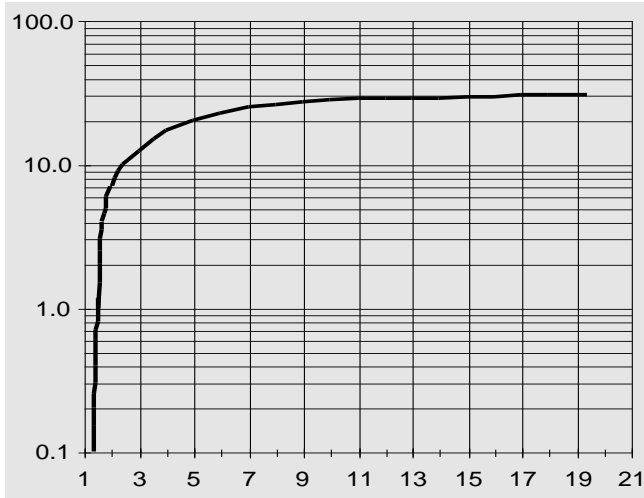
Figura 2. Función empírica de Peterson para estimar el coeficiente \phi de 1 a 21.
